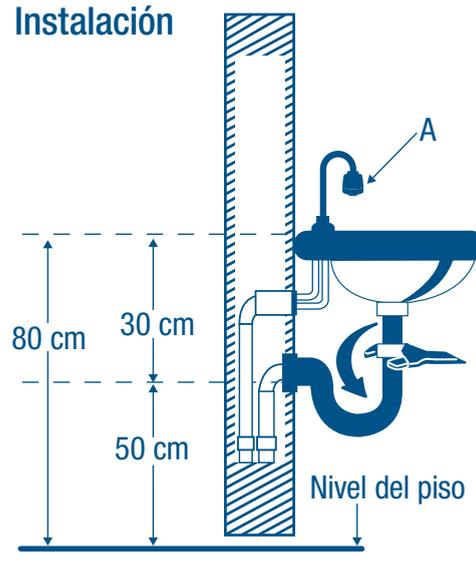
Medida recomendada. Coloque la mezcladora (A) Nota: En todas las uniones roscadas utilizar cinta teflón, para evitar fugas.
